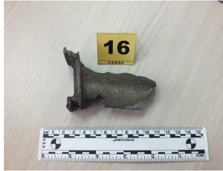
Alabes de rueda de turbina arrojados por el motor N°1 (encontrados en tejados circundantes a la pista 13R)
