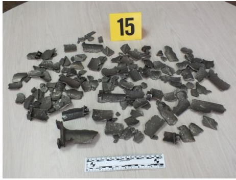
Alabes de rueda de turbina arrojados por el motor N°1 (encontrados en tejados circundantes a la pista 13R)
